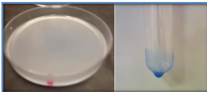
Figura 1. Confirmación de la formación de la película y adherencia del producto sellador post-ordeña con una viscosidad de 250 ctp determinada con aguja No 2 del viscosímetro (Broockfield).
