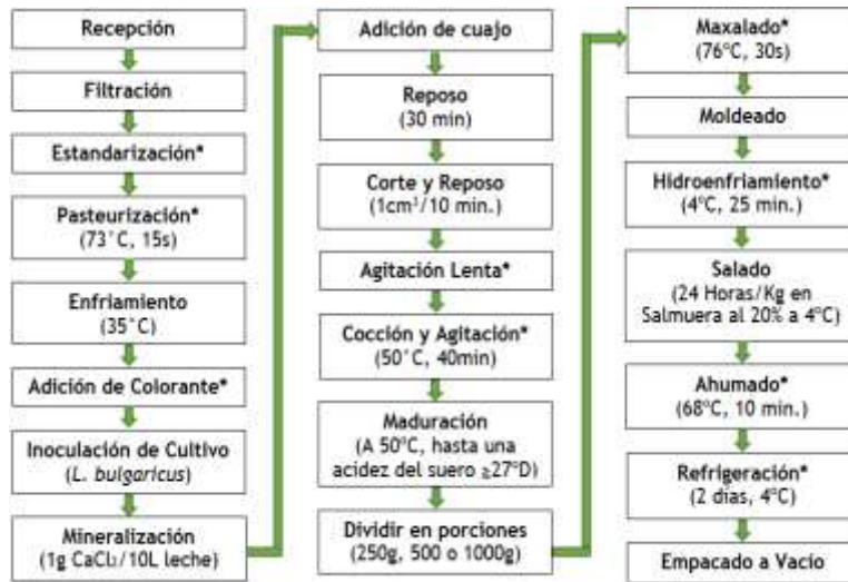
Figura 2. Diagrama de flujo propuesto para la fabricación de queso provolone ahumado. * Cambios propuestos en las operaciones del proceso.
