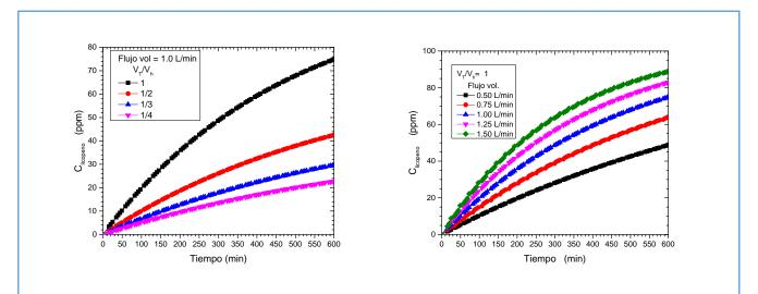
Figura 2 Resultados del modelado del sistema de extracción sólido-líquido tipo batch para una masa de 10 kg de hojuelas de jitomate deshidratado y V₁ de 50L.
