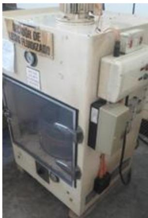
**Figura 2.** Secador de lecho fluidizado *Apex* modelo SSE65
