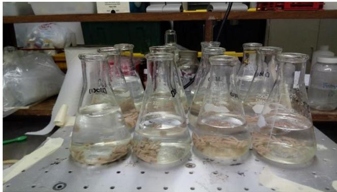
Figura 2. Metodología utilizada para la determinación de estabilidad de dietas experimentales (modo de agitación de las dietas en agua destilada).
