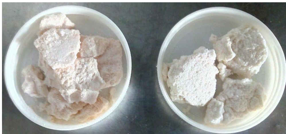
Figura 5. Apariencia de los terrones desecados de quitosanos obtenidos en el laboratorio de tecnología de alimentos de la UAA. De izquierda a derecha quitosano de camarón de altamar (C-A) y de camarón de estero (C-E).
