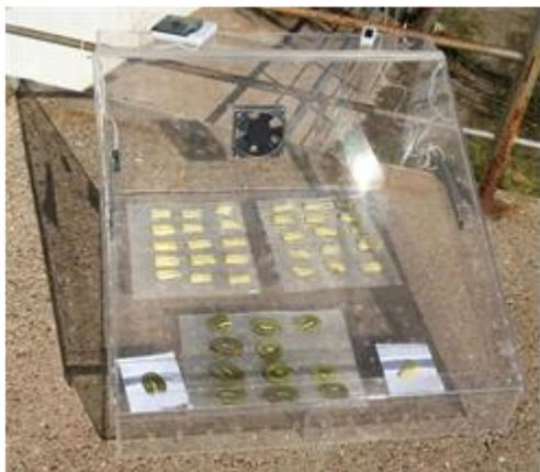
**Figura 1.** Secador por convección Natural.
