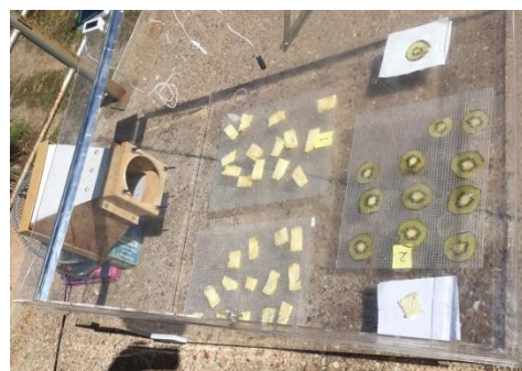
Figura 2. Secado directo operando en convección forzada.
