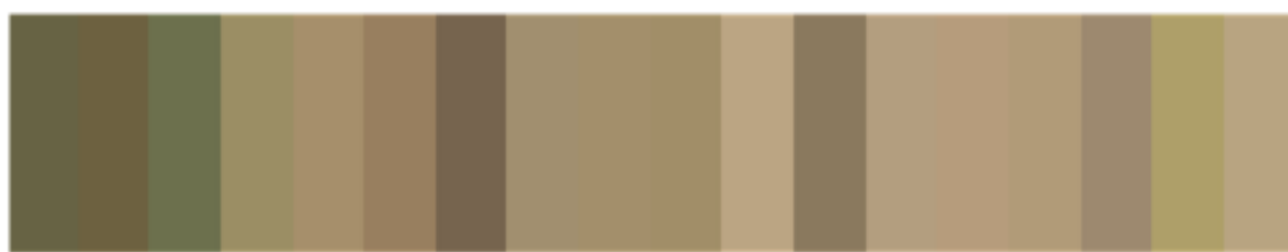
Figura 9. Evolución del color en la deshidratación empleando convección natural.
