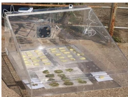
Figura 1. Secador directo operando en convección natural.
