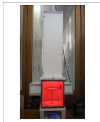
*Figura 1. Equipo de radiación infrarroja*
