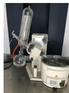
Figura 3.- Evaporación de solvente.
