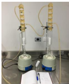
Figura 2.- Determinación del contenido de aceite por Soxhlet.
